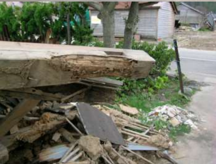
モルタル塗り改装 による柱下部・土台 の腐朽
